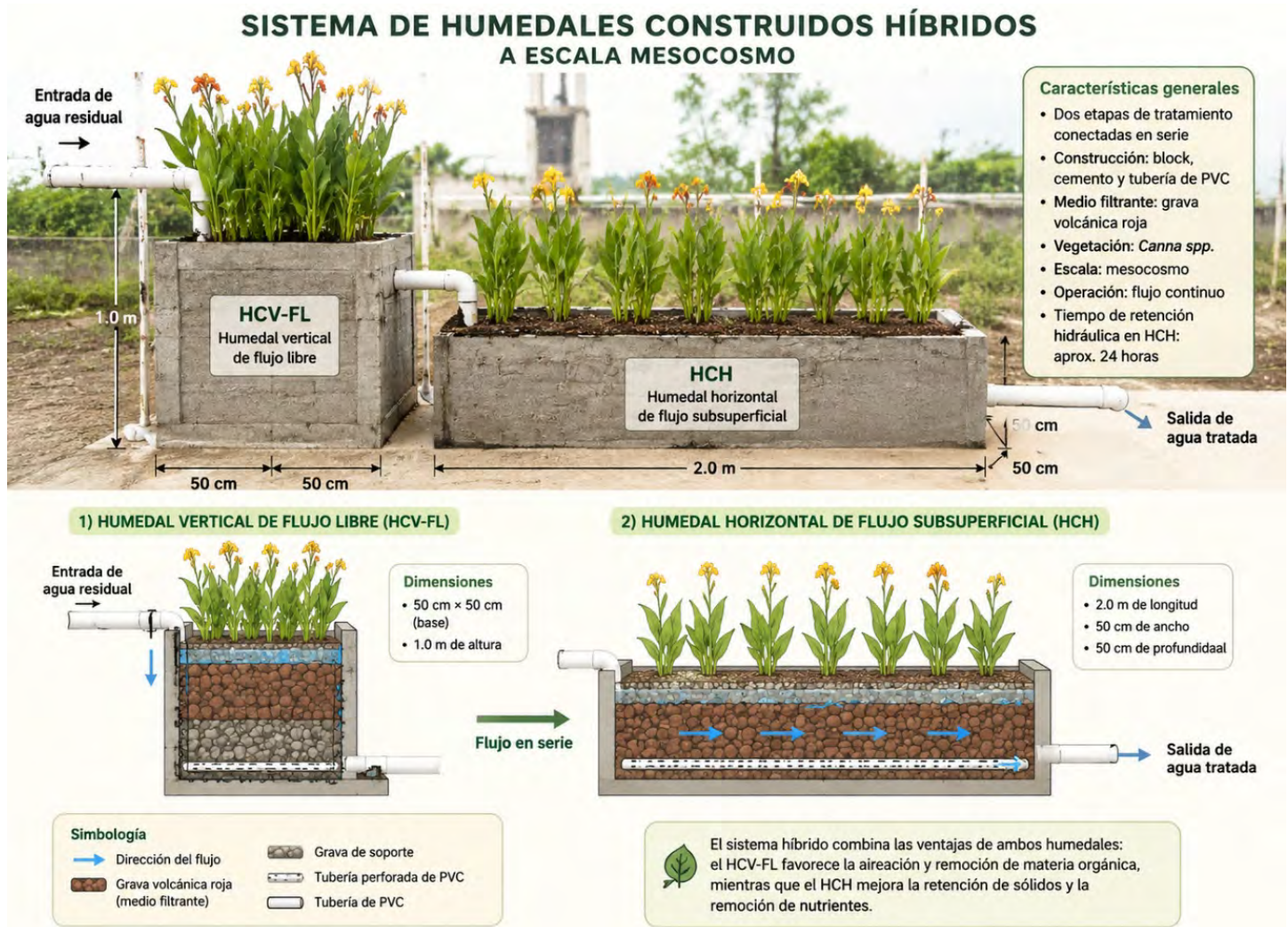
Figura 1. Representación del Sistema de Humedales Construidos Híbridos del IT de Úrsulo Galván. Imagen generada con IA.
