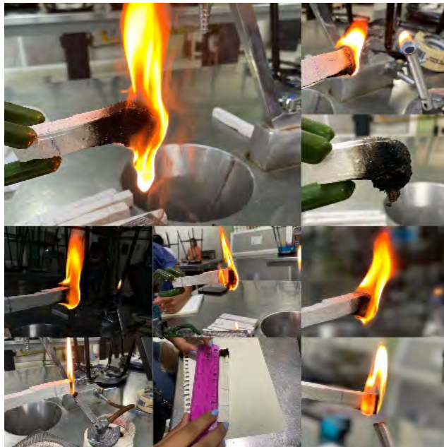
Figura 83 Prueba de velocidad de flamabilidad-b
