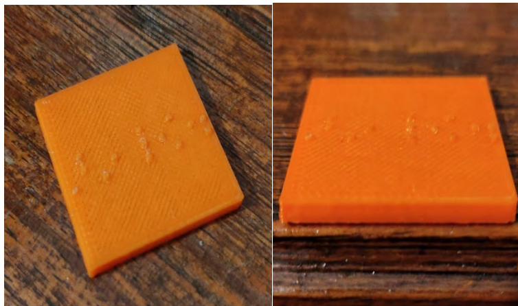
Figura 39 Placa prototipo para verificar legibilidad del braille diseñado en SolidWorks
