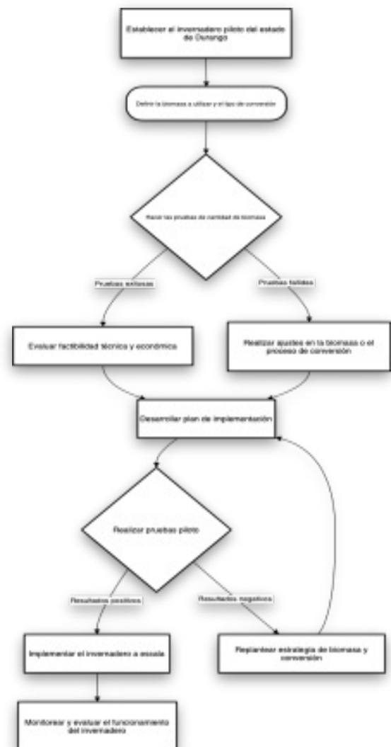
Figura 3. Diagrama de flujo para la validación y pruebas del prototipo piloto usando biomasa como fuente de energía para automatizar invernaderos.
