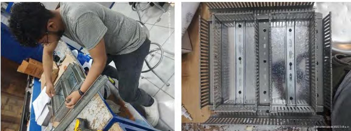
Imagen 10.- Integración del panel eléctrico.
