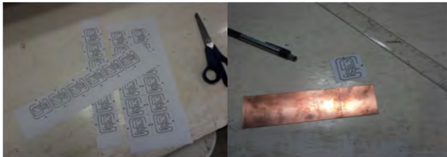
Imagen 12. Circuito impreso en papel transfer listo para el proceso de planchado a la placa de placa fenólica o baquelita.
