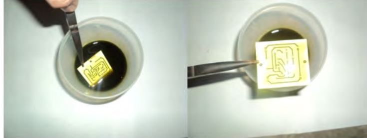
Imagen 14. Revelado del circuito en cloruro férrico.
