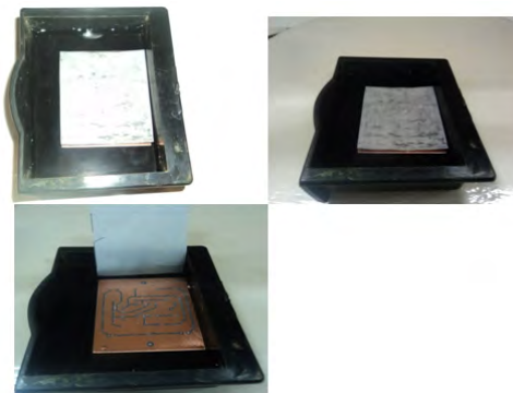
Imagen 13. Revelado de las pistas del circuito en agua después del planchado.
