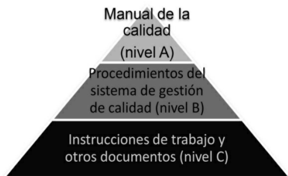
Figura: 11. Jerarquía típica de la documentación del sistema de gestión de calidad. Fuente: propia.
