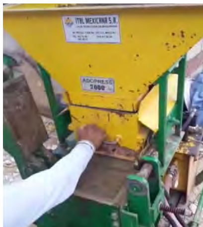
Figura 3. Máquina ADOPRESS 2000. Los BTC fueron elaborados en la ciudad de Tuxtla Gutiérrez en 2018.
