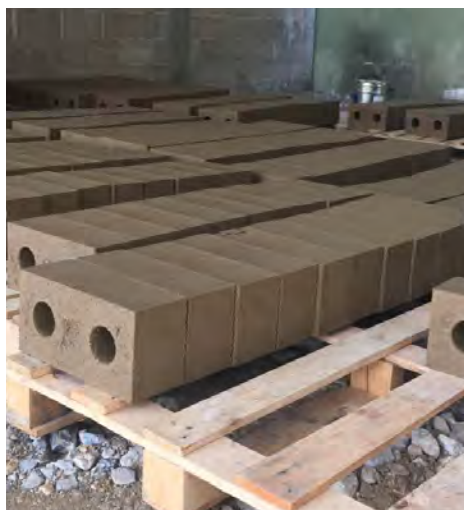
Figura 4. Bloque de Tierra Comprimida (BTC) perforada. El secado se realizó sobre tarimas para evitar el contacto directo con el agua en Tuxtla Gutiérrez durante 2018.
