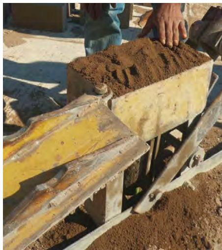
Figura 2. Máquina manual para la elaboración de Bloques de Tierra Comprimida (BTC) denominada CINVA-RAM. Nota: La máquina fue elaborada de forma intuitiva en la ciudad de Tuxtla Gutiérrez en el año 2017.
