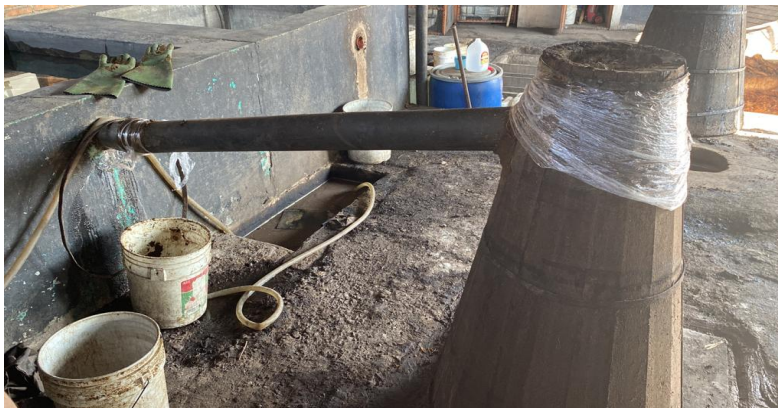
Figura 14: Alambique conectado hacia la tina de enfriamiento
