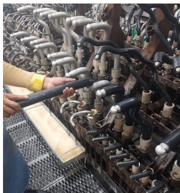
Fig. 3. Aplicación de lubricante sobre mandriles
