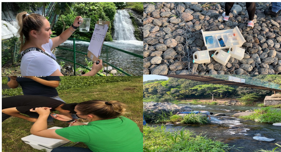
Fig. 1 Muestreo in situ de agua en el Río Actopan, para la determinación de metales pesados.
