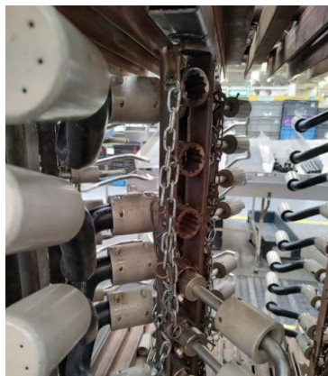
Fig. 13. Seguros soldados con cadena sobre la base de colocación de mandriles
