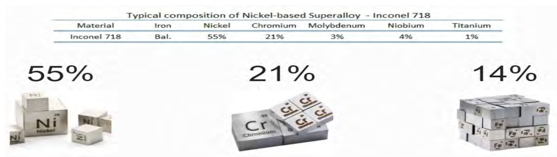
Figura 1. Composición química del INCONEL 718 [Tomado de "material-properties.org"]
