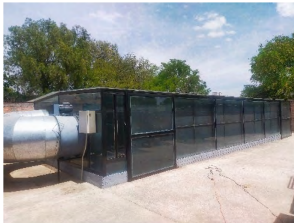
Figura 1: Fotografía del secador solar directo con convección forzada tipo invernadero.
