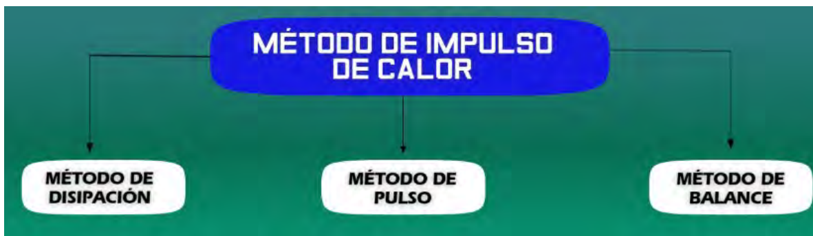
Figura 2. Técnicas de medición en el Método de Impulso de Calor.
