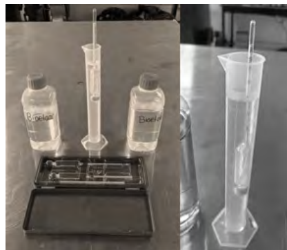
Figura 9. Medición de grados de alcohol por medio de un densímetro y termómetro.
