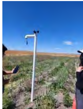
IMAGEN 2.- Pruebas de unidad meteorológica sensores de humedad, temperatura , velocidad del viento, fecha y hora.
