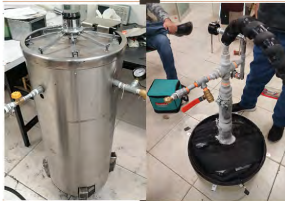
Fig. 5 cámara de criogenia y tanque de alimentación de nitrógeno
