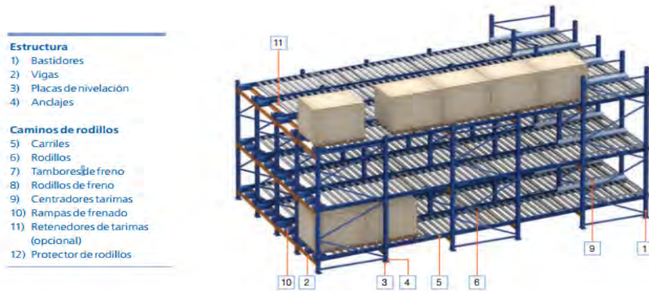
Figura 3. Partes del rack dinámico
