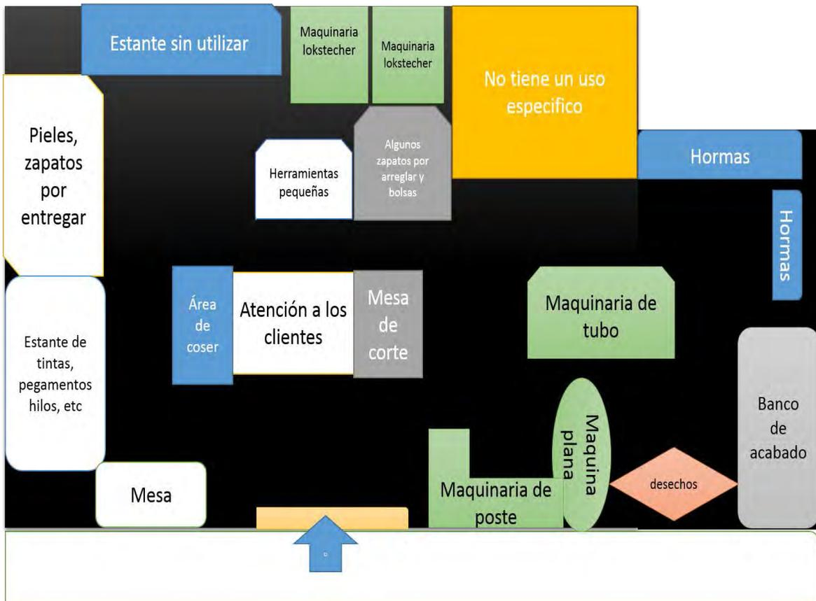
Analizando la figura anterior y conociendo el proceso de elaboración de zapatos se propuso la siguiente ubicación dentro del lugar. Permite que sea más rápido el proceso y no se pierda tiempo para llegar a la maquinaria tomando cuenta una línea de producción.
