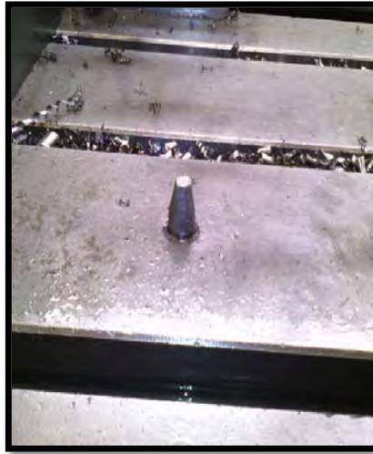
El tiempo de perforación tiene un promedio de 77.87 minutos, tiempo suficiente para que el operador realice la preparación de la plantilla para la siguiente pieza. Entonces el tiempo de producto se reduce al necesario para retirar la plantilla en uso, traslado al área de preparación y cambio por la nueva plantilla, presentando un ahorro importante de tiempo y efectividad de la operación. La figura 5 muestra el funcionamiento general del sistema implementado.
