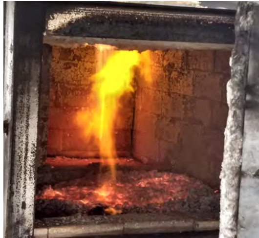
Figura II: Pollinaza en combustión dentro del horno de incineración de mascotas.
