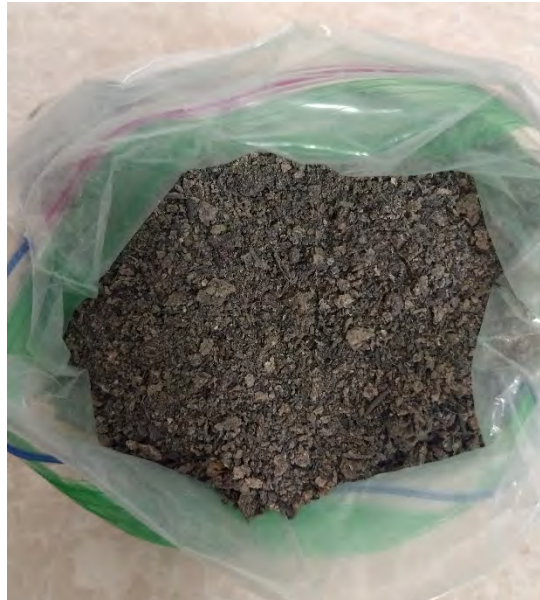
Figura IV: Cenizas de pollinaza obtenidas por horno de incineración de mascotas.
