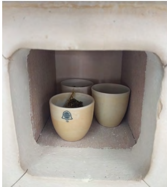
Figura I: Muestras de pollinaza puestas en los crisoles y dentro de la mufla.
