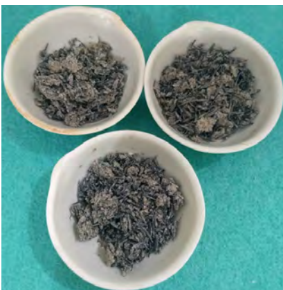
Figura III: Cenizas de pollinaza obtenidas por mufla.
