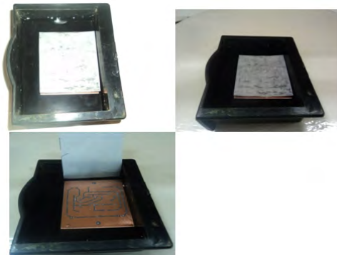
Imagen 13. Revelado de las pistas del circuito en agua después del planchado.
