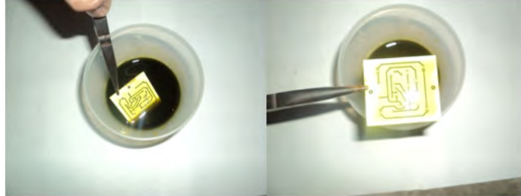
Imagen 14. Revelado del circuito en cloruro férrico.
