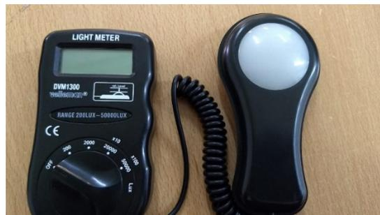
Una vez que se han encendido las luminarias previas a las mediciones tenemos que dividir el área de trabajo en diferentes secciones, esto generalmente es en las secciones en las que se encuentran ubicadas las luminarias. Cuando se realizan las mediciones se debe tener perfectamente distribuido el espacio y no solo se debe tomar una medición, si no varias, a diferentes horas del día. El área de trabajo debe de estar despejada como se puede ver en la Figura 4.
