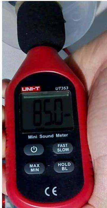
El resultado de la lectura del sonómetro es de 85 dB aproximadamente, con este valor se realiza una comparación con los resultados obtenidos en el microprocesador, en la figura 8 se observa el cambio en las lecturas al momento que empezó a producir ruido el generador de frecuencias.
