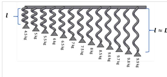
**Figura 3.** Estiramiento mecánico de un resorte
