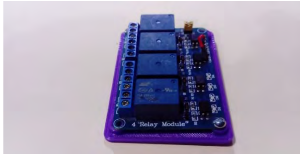
Figura 8. Base con módulos relevadores.
