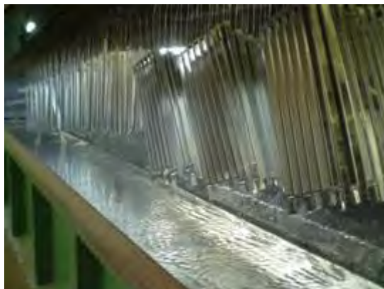
Figura 4. Inmersión en baño de zinc fundido (Unizinc, 2019)
