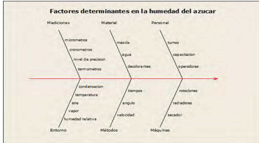
Figura 3.72. Diagrama causa-efecto de los factores que determinan la humedad de azúcar.
