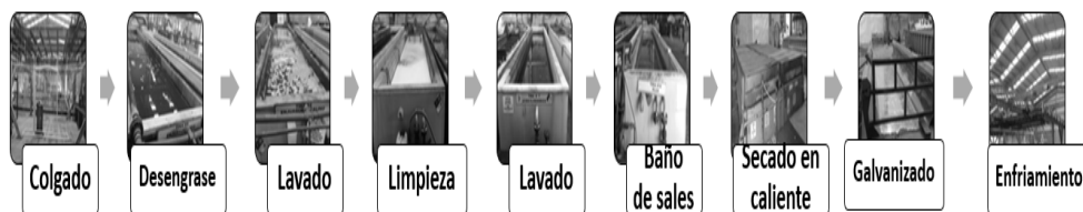
Figura 3.78. Proceso de galvanizado por inmersión en caliente, por etapas.
