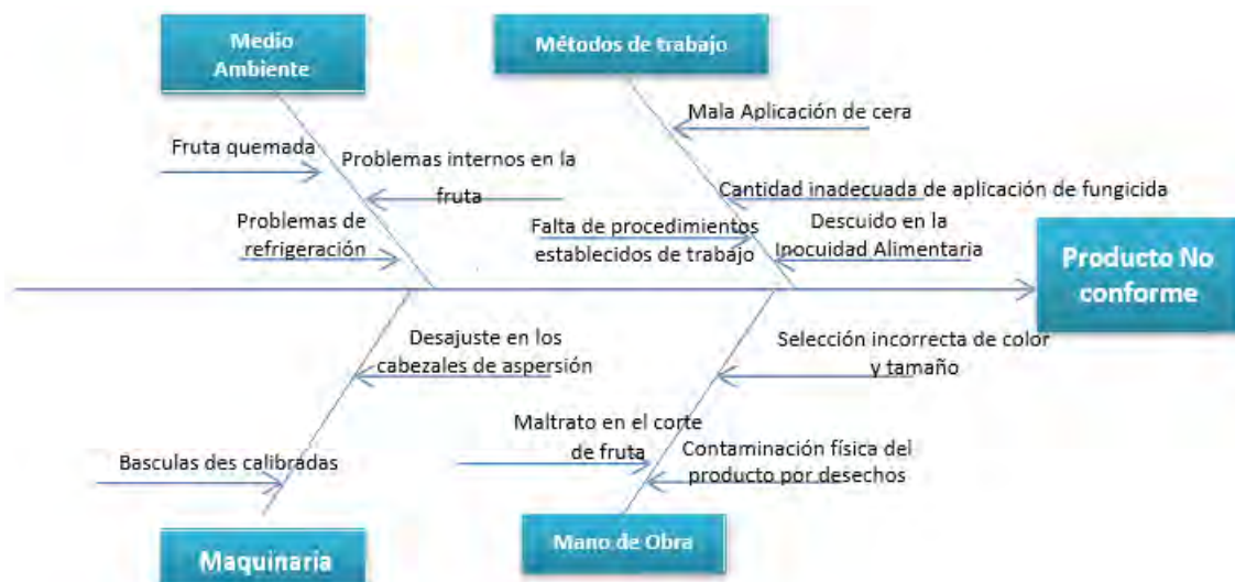
Figura 3.42. Diagrama causa-efecto de los factores que determinan el producto no conforme.
