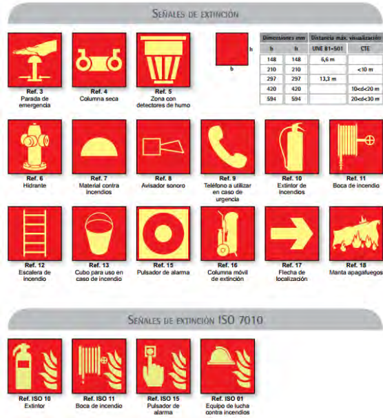
Figura 11 Señales de Extinción
