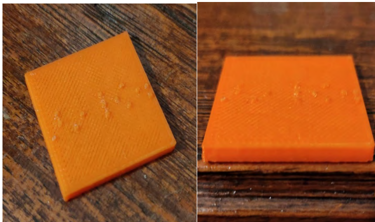
Figura 39 Placa prototipo para verificar legibilidad del braille diseñado en SolidWorks
