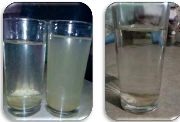
En la figura 1 se observa agua residual proveniente de uso doméstico (izquierda) con la aplicación y clarificación con alumbre (derecha).
