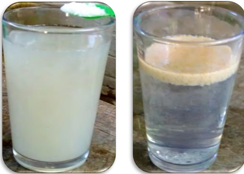
A la izquierda se observa el agua combinada y aplicación de alumbre, a la derecha se aprecia la clarificación del agua.
