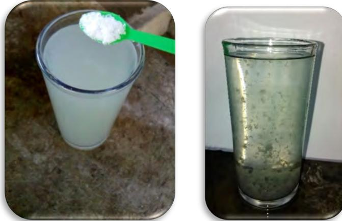
En la figura 2 se muestra agua proveniente de su utilización en lavadora con la aplicación de alumbre (izquierda) y el resultado de la clarificación (derecha).
