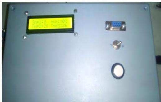
En la figura 23 se muestra las conexiones del gabinete hacia los sensores externos utilizando conectores Db9, un conector es para los sensores de temperatura ds18b20, otro conector soporta los sensores con comunicación IIC de 3.3 Vcd y 5 Vcd, el último conector se encuentra destinado para el sensor DHT11 y el sensor ultrasónico.
