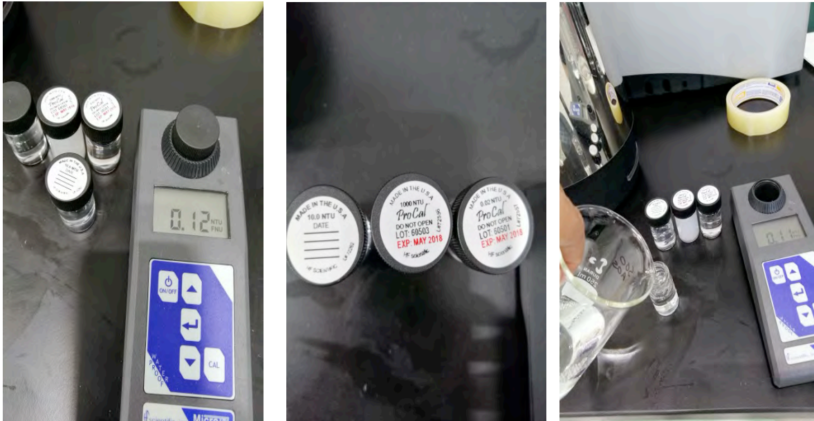
Fig. 2 Medición de turbidez en las muestras a diferentes concentraciones, empleando el turbidímetro portátil.
