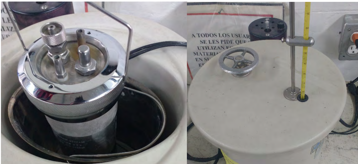
Figura 1. Montaje de la bomba calorimétrica, donde: a) introducción del recipiente con la muestra combustible y b) Montaje de tapa y termómetro de la bomba calorimétrica
