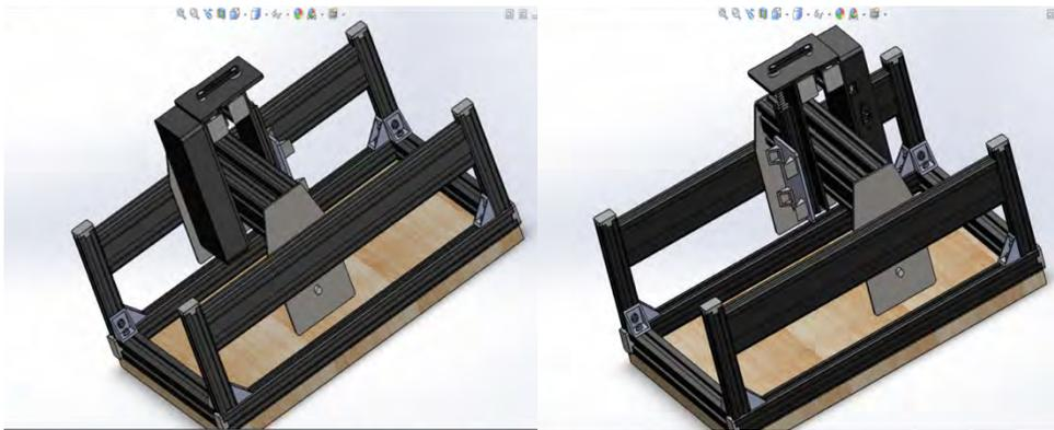
*Ilustración 11. Del lado izquierdo se muestra la vista superior y del lado derecho la vista frontal del diseño final del Router.*
