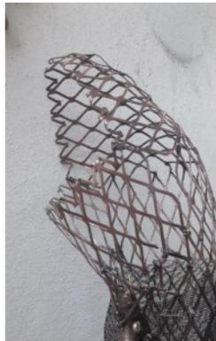
*Figura 4.* Estructura del cabezal del dispositivo final para recolectar pitaya de mayo.
