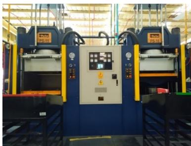
Las prensas de compresión del molde se fabrican en una amplia variedad de tamaños. La mayoría de las prensas utilizan un cilindro hidráulico con el fin de producir la suficiente fuerza durante la operación de moldeo. Las prensas pueden generar presiones que van desde 300 a 4.000 toneladas.
