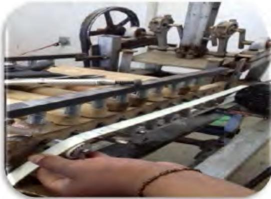
Imagen 1.55 Ensamblado de banda dentada
