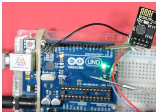
Después de que el módulo ESP8266 se encuentra listo para ser programado en el monitor serial se escribe el comando AT, Fig. 10.
