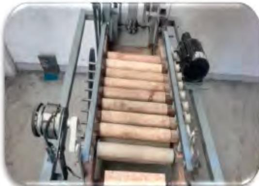
Imagen 1.58 Colocación de banda dentada en engrane
