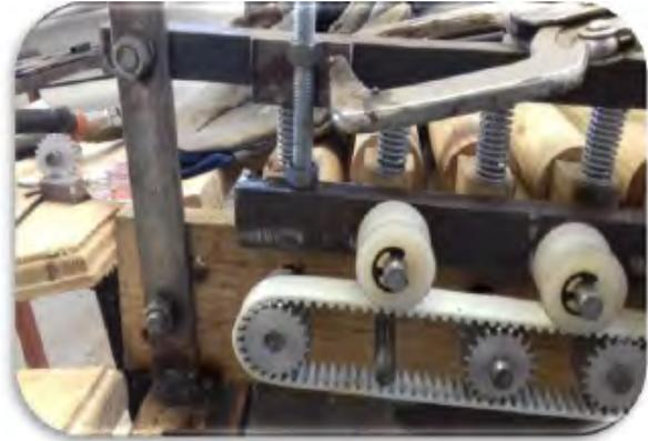
En la colocación de la banda es necesario tomar algunas medidas para saber que distancia va ser requerida para el corte una vez teniendo la medida establecida se procede a la colocación en los tres engranes correspondientes y ajustando el motor al tensión requerida.
