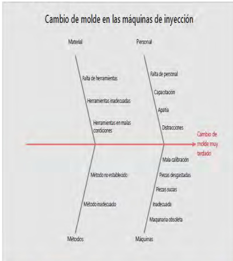
Figura 1. Diagrama de Ishikawa del cambio de molde en la máquina de inyección
