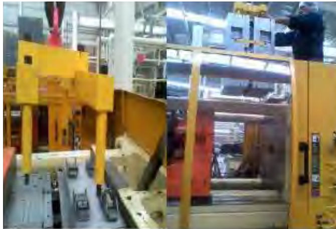
Figura 3. Actividades del cambio de molde
