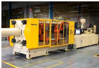
**Figura 8** Maquina de moldeo por inyección HUSKY.
