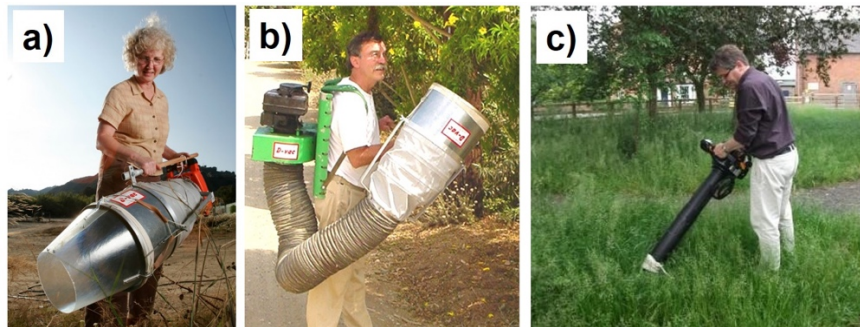
Figura 7. Aspiradoras entomológicas modernas. a) D-Vac de mano, b) D-Vac de mochila y c) G-vac (Tomado de Don't Forget the Roundabouts, 2018).
