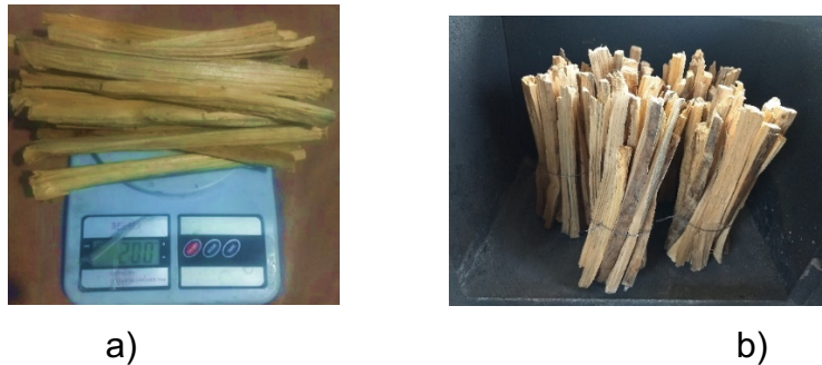
Figura 2. Cuantificación de biomasa en tiras y b) acomodo inicial en el hogar de combustión.
