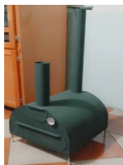
Figura 4. Estufa para la combustión de las briquetas de biomasa sólida.
