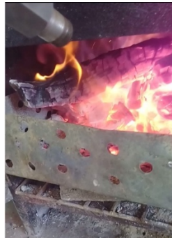
Figura 6. Resultado representativo del direccionamiento de vapor al hogar de combustión.
