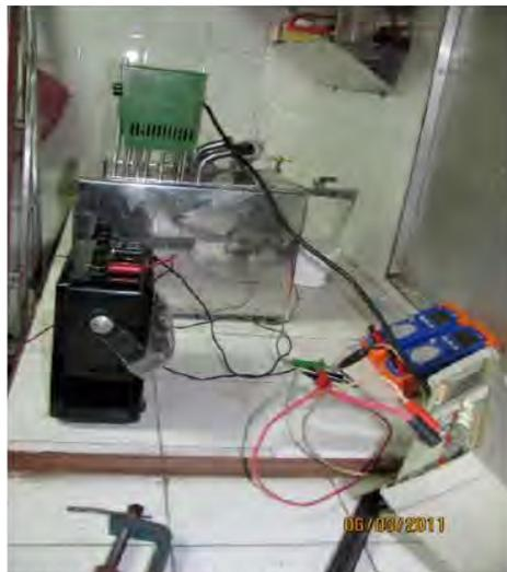
Se muestra el montaje experimental armado para el análisis del comportamiento se realizaron tres gráficas, la primera gráfica de voltaje producido por la celda a circuito abierto, La diferencia de temperatura es entre las caras de la celda donde las superficies se aislaron y una de ellas se refrigera de manera de tener está a temperatura constante.
