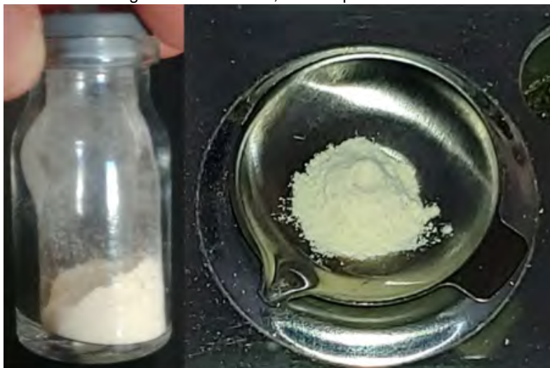
Figura 7. Polvo obtenido de ZnO/ALX obtenidas en el experimento 1. Se aprecia la apariencia uniforme, color blanco ligeramente amarillo, libre de partículas extrañas.
