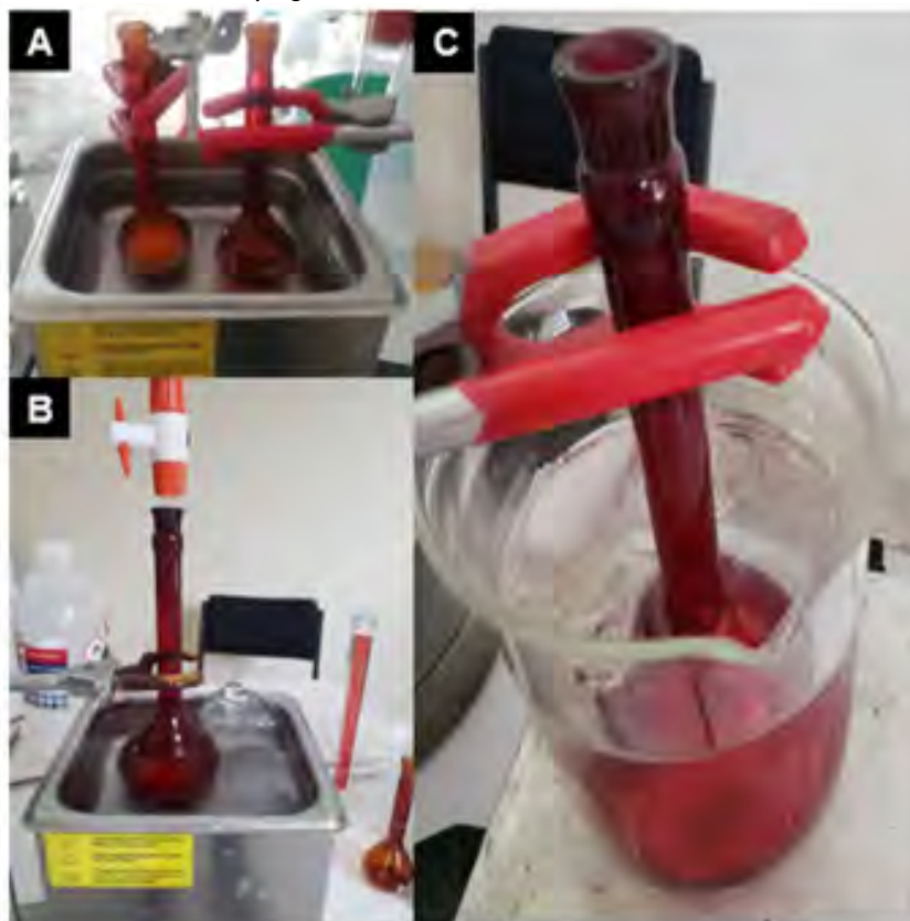
Figura 6. Dispositivo para la obtención de nanomatrices de ZnO/ALX. A) Disoluciones individuales y homogéneas de ZnO y ALX en MetOH a 4°C. B) Elaboración nanomatrices de ZnO/ALX con ultrasonido a 4°C. C) Agitación constante durante 10 h a 4°C.
