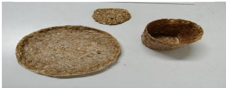
Además, que con las pruebas realizadas posteriormente este tiene una resistencia media ya que puede soportar 1.5 kg de materia en este, en el caso de la biodegradabilidad se probaron 3 tipos de ambiente, en el primero una atmosfera cerrada que solo contenía tierra y agua se degrado en 100 días, en un ambiente abierto aproximadamente 60 días y en cuanto a su degradabilidad en agua fue en
