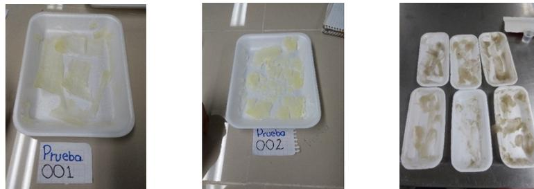
En la imagen 2 se observa que las primeras matrices realizadas se rompían ya que las variables que se utilizaban como lo son temperaturas y concentraciones no eran adecuadas. Se realizaron más pruebas hasta llegar a las variables idóneas donde el bioplástico ya no sufriera rupturas como se muestra en la imagen 3.
