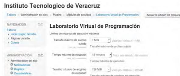
Una vez estando en la configuración de VPL, lo que hay que cambiar es la configuración del servidor de ejecución, por defecto estará enlazado al servidor de ejecución Demo que proporciona VPL, y en su lugar hay que poner la dirección de donde se encuentre el servidor de ejecución previamente creado, en este caso la dirección URL es la misma que la IP, puesto a que a sea está conectado el servidor, de tal forma que la configuración queda de la siguiente manera, observe la figura 42:
