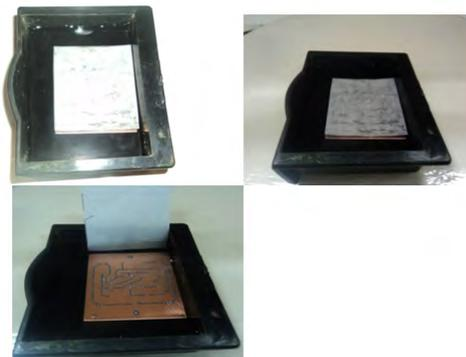
Ahora aplicamos el proceso de revelado por el cloruro férrico, liquido especial para reaccionar con el cobre de la placa de baquelita observe la siguiente imagen.
