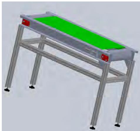
El diseño de la banda transportado está basado en el conocimiento de los materiales a transportar, para este caso piezas de polímero y aluminio, de dimensión y peso específico. Para mejorar el funcionamiento del sistema, se pretende hacer uso de guías para mantener centrado el transporte de los elementos.
