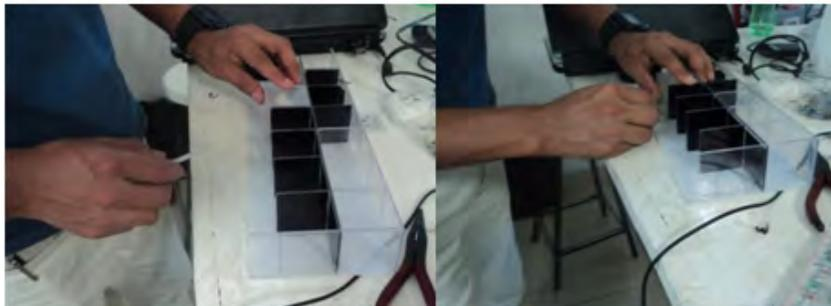
Se realizan las pruebas piloto como se observa en la imagen 8, el sensor antes practicado y el material que se empleará para el prototipo, también con diferente grosor de los acrílicos y micas desde 3 mm a 6 mm de espesor, aquí solo se muestran tres primeros sensores de los trece a instalar.
