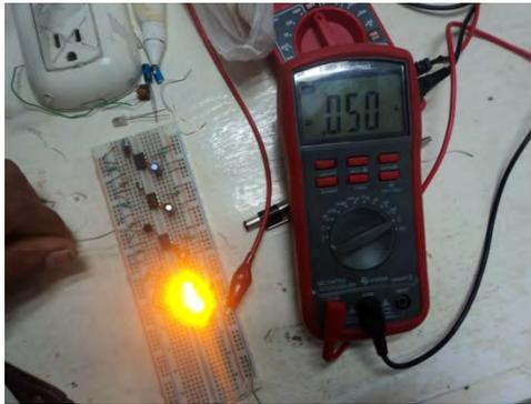
En la imagen anterior solo se emplearon 3 leds amarillos cuyo voltaje o tensión umbral es de 2.1 V, esto implica una caída de tensión, los 5 V son repartido en una proporción de 1.6 V aproximadamente, por lo tanto para lograr un buen brillo con 4 leds será necesario alimentar los circuitos con 12 V respetando la corriente y el voltaje umbral de cada tipo de led que se emplee y así determinar la resistencia adecuada para soportar la corriente que lo atraviese
