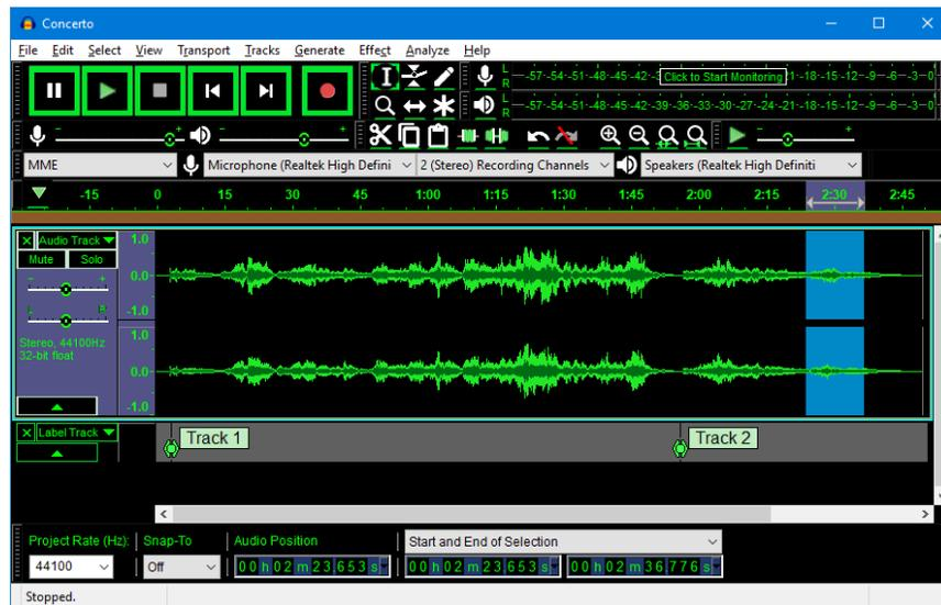
Existen diferentes softwares de audio gratuito, de código abierto y multiplataforma por ejemplo Audacity (Figura 14) es un editor y grabador de audio multipista fácil de usar para Windows, Mac OS X, GNU / Linux y otros sistemas operativos.
