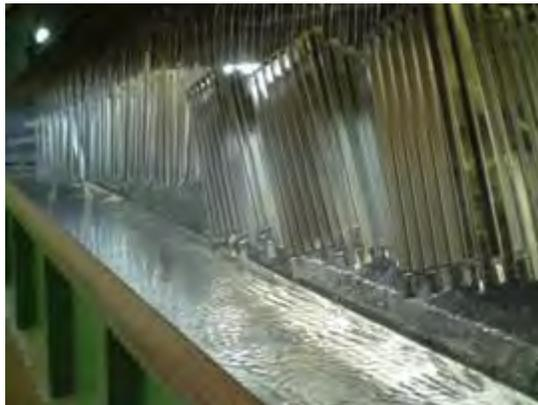
La temperatura es uno de los parámetros más importantes, ya que repercute directamente en el costo del proceso, dado que a una mayor temperatura de proceso equivale a un mayor consumo energético y un menor intervalo de temperatura repercute directamente en el acabado superficial de la pieza. (D. Hernández y Hernández, 2017).
