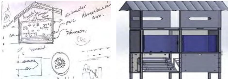
El primer nivel está destinado a la crianza de peces (acuaponía) debe contar con una estructura metálica de que tenga soportes en los costados y en la base principal, donde los peces deberán desarrollarse, dicho contenedor deberá diseñarse con un sistema de filtraje, recirculación, censado de PH, un sistema de calentamiento y oxigenación del agua, controlado con un sistema de adquisición de datos y control automático.
