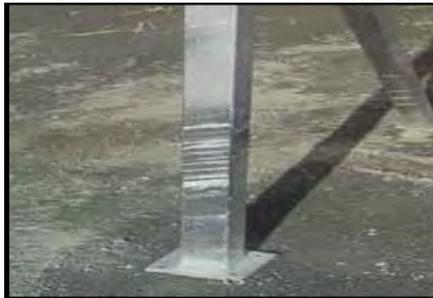
Figura 12. Superficie rugosa (CEMESA Galvanizadora, 2015).
