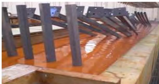
Secado: se debe realizar un secado previo a la inmersión en el baño de zinc, exponiendo la pieza al aire por aproximadamente 5 minutos. Es importante que la pieza se encuentre completamente seca antes de su inmersión en el baño de zinc, ya que de lo contrario la vaporación súbita del agua, producirá una reacción de zinc fundido por toda el área de trabajo con riesgo de seguridad para los trabajadores y perdida de zinc (Association american galvanizers, 2015).
