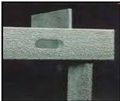
Superficie rugosa: El recubrimiento áspero ocurre debido a la composición química de la superficie de acero o el estado superficial de la pieza. Estos factores se encuentran fuera del control del galvanizador. La rugosidad también puede ser originada en el proceso de galvanización por el exceso de extracción, la inmersión por tiempo prolongado del tanque de galvanización o la lata temperatura del zinc fundido.
