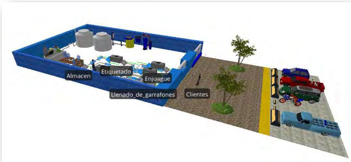
Figura 25. Vista frontal del modelo de simulación en Simio.
