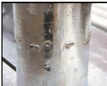
Agujeros obstruidos: los agujeros tapados son causados por un drenaje inadecuado y pueden llenar parcial o completamente los agujeros de zinc. El zinc fundido no desagua fácilmente en los agujeros menores de  $3/32$  (3mm) de diámetro debido a la viscosidad del metal de zinc, por lo que se debe considerar hacer perforaciones con el mayor diámetro posible. Agujeros de menos de  $1/2$ " (12.7 mm) de diámetro no son causa para el rechazo. Como se muestra en la figura 9.
