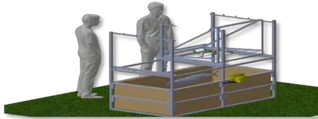
El tercer nivel destinado a la crianza de aves de corral, deberá contar con una estructura de soporte formada con ángulos de 1" y con un techo de lámina, deberá diseñarse un sistema mecánico donde se concentren los desechos, un sistema de calefacción, un sistema de oxigenación, y un sistema de extracción de gas amoníaco, que tiende a enfermar de vías respiratorias a las aves.
