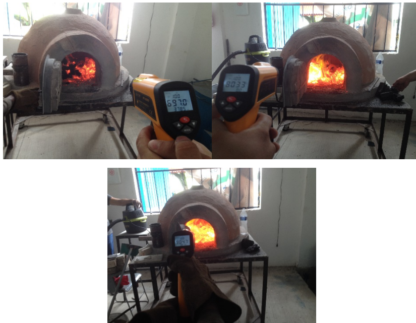
Figura 14. Horno puesto en operación en modo seguro.
