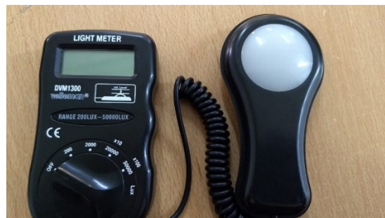
Figura 3. Luxómetro, aparato usado para medir la cantidad de iluminación que existe en un espacio determinado.
