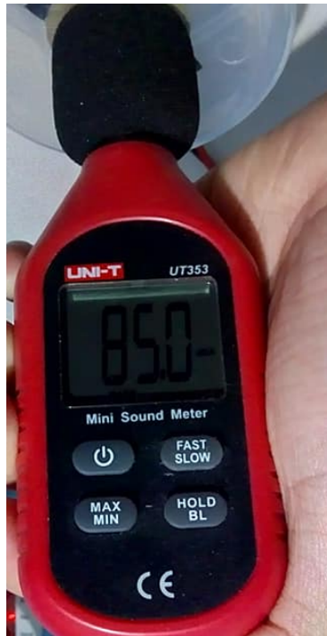
Figura 7. Lectura del sonómetro con la intensidad más pequeña del generador de frecuencia
