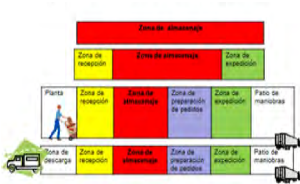
Figura 2. Zona de almacenaje
